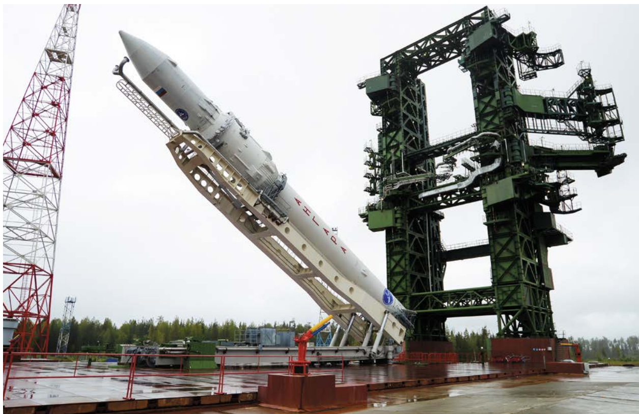
Установка РКН «Ангара-1.2» на ПУ УСК. Космодром Плесецк, апрель 2014 г.
