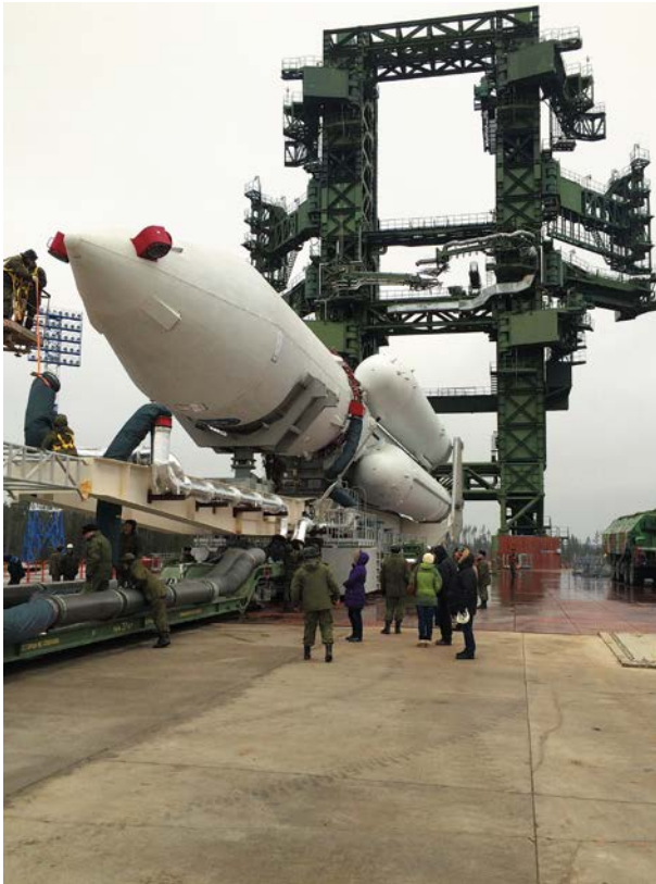
Установка РКН «Ангара-А5» на УСК. Космодром Плесецк, 11.11.2014 г.
