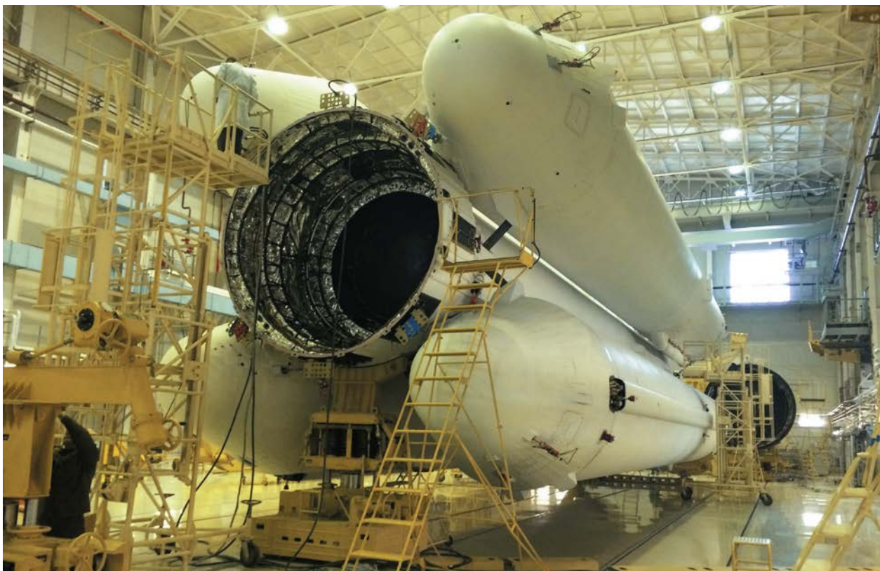
Ведется подготовка к сборке с III ступенью РН «Ангара-А5» на ТК. Космодром Плесецк, 18.10.2014 г.
