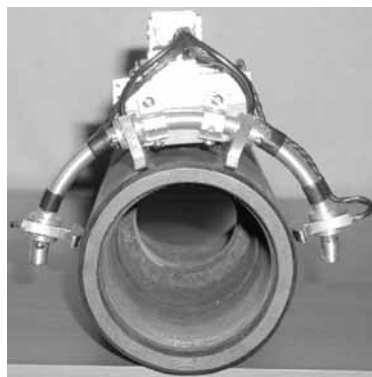
Рис. 2. Многоканальное сканирующее устройство для контроля гибов и трубопроводов
